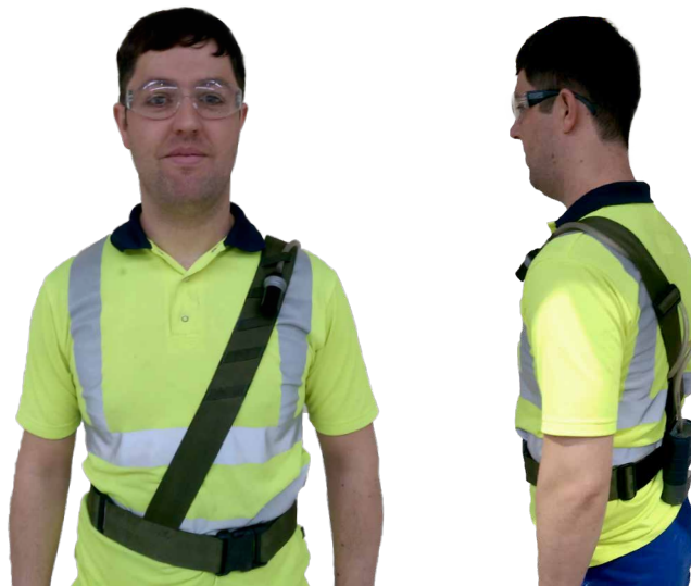
Abb. 1 und 2: Persönliches Luftprobenentnahmeggerät für Faserstaub
