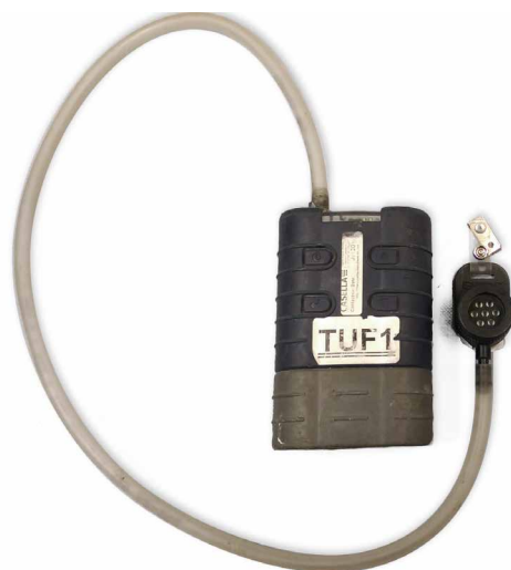
Abb. 3: Probenahmeanordnung UKEA-Kopf (Gesamtstaub)
