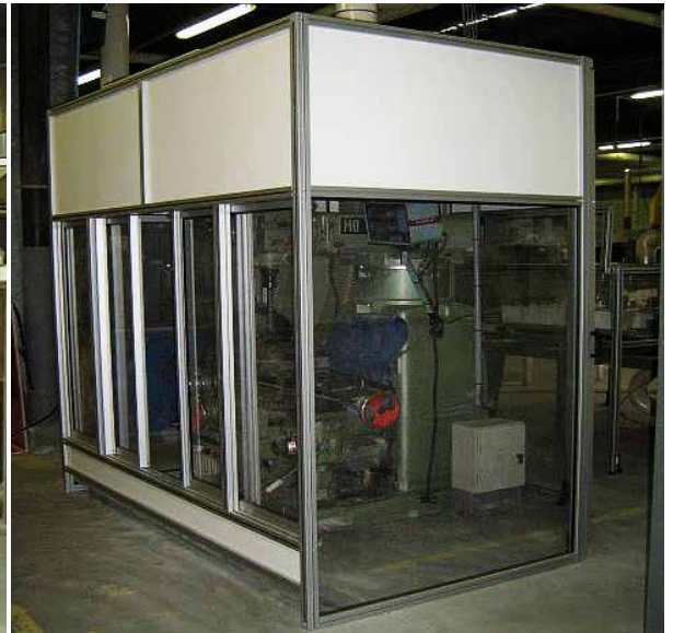
Fraiseuse entièrement fermée
