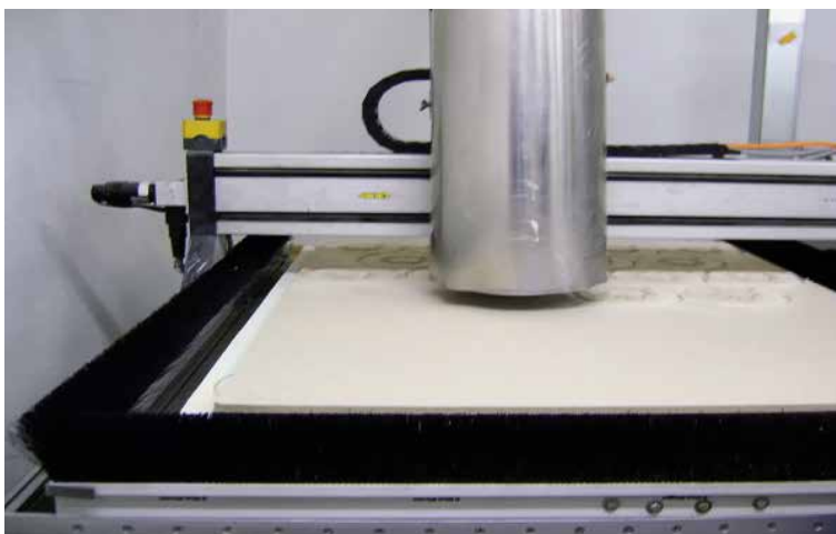
CNC avec aspiration localisée sur l'outil
