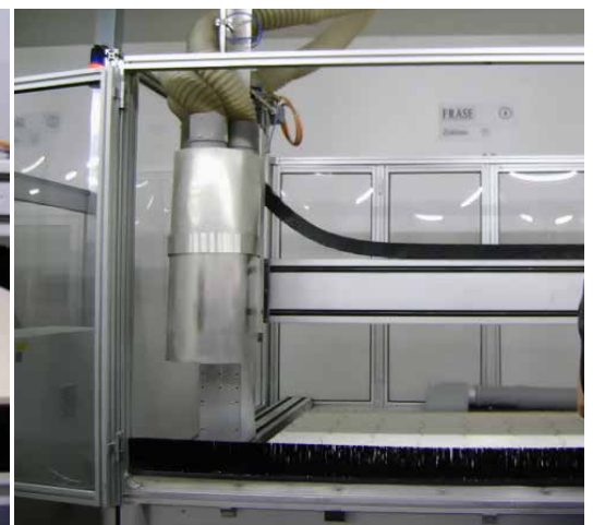
CNC avec encoffrement partiel et aspiration localisée sur l'outil
