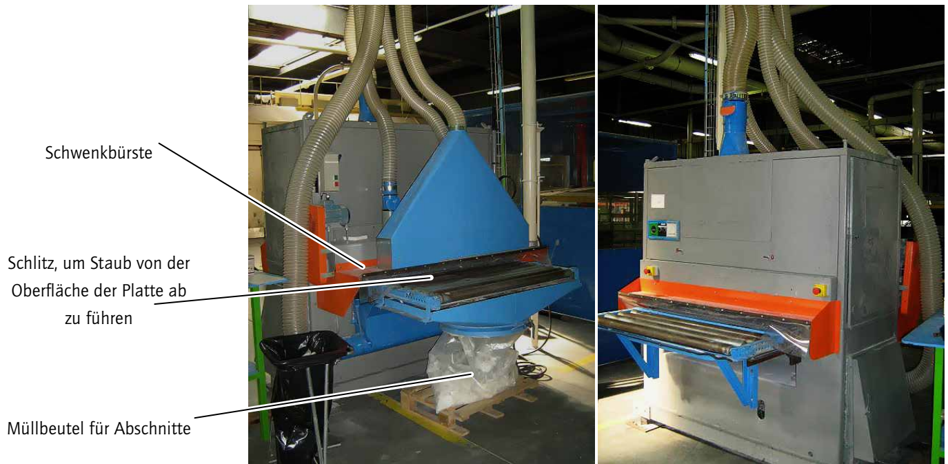
Schleifmaschine mit stationärer Absaugung / Horizontalschleifer
