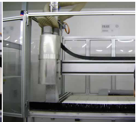
CNC mit teilweiser Einhausung stationärer Absaugung am Werkzeug
