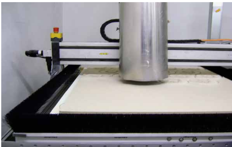
CNC mit stationärer Absaugung am Werkzeug
