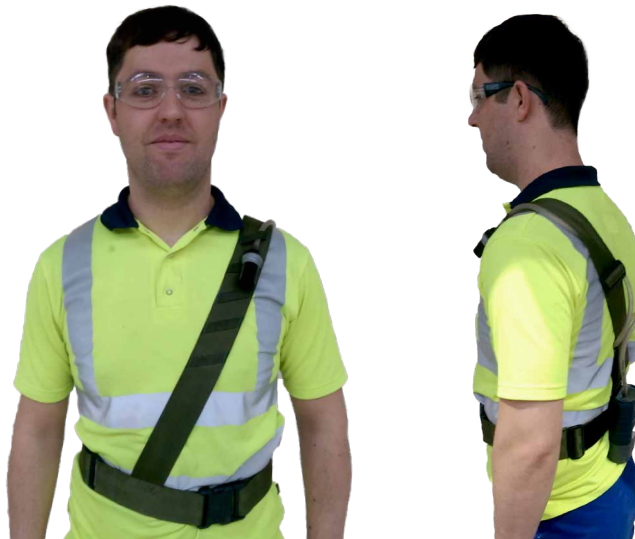
Fig. 1 & 2 : Unité individuelle de prélèvement d'air pour fibres en suspension dans l'air
