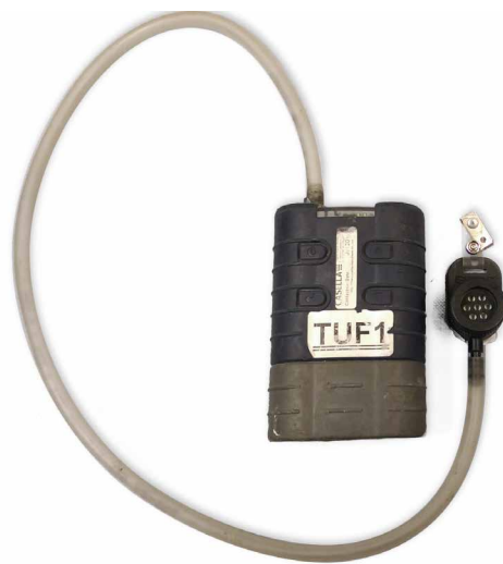
Fig. 3 : tête d'échantillonnage UKEA (poussière totale)
