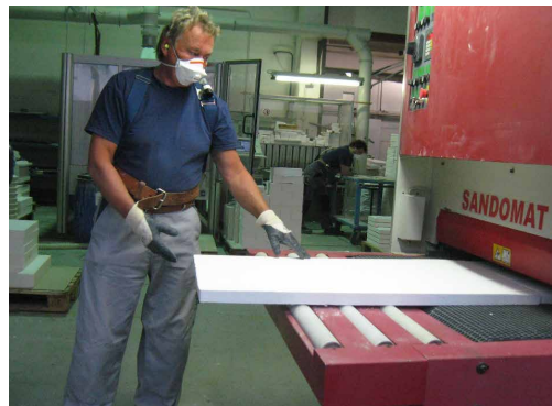
Ponçuse à bande partiellement encoffrée avec extraction à la source
