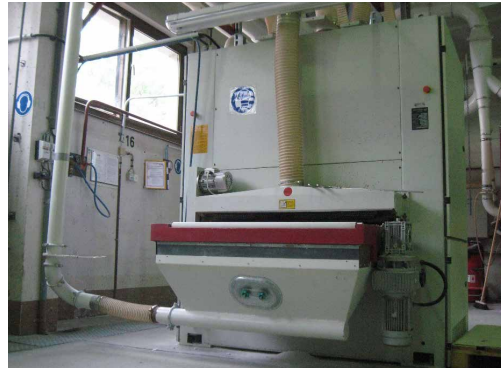
Ponçuse à bande (complètement encoffrée)
