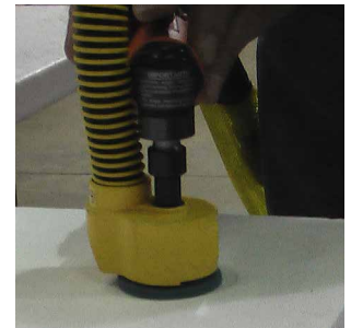
Fig. 1: Aspiration localisée sur outil portatif
