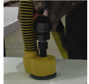
Abb. 1: lokale Absaugung am Werkzeug
