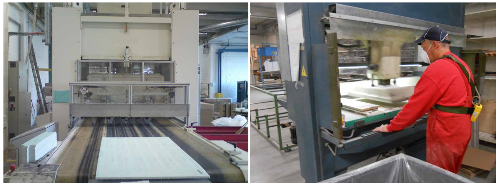
Opération de découpe encoffrée
