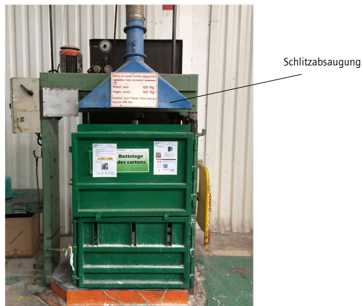
Abb. 2: Presse für leere Säcke mit Erfassungshaube (Schlitzabsaugung), die mit dem stationären Absaugsystem verbunden ist
