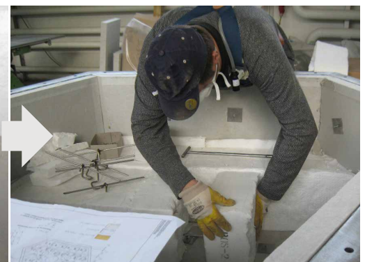
Abb. 12: Modul auf Pins drücken
