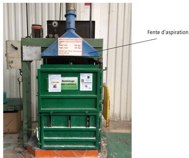
Fig. 2 : Presse pour sacs vides avec un système de captation (fente d'aspiration) lié à une VCS
